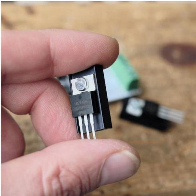
Si vous utilisez des dissipateurs thermiques, montez dès à présent les mosfets dessus. Ajouter de la pâte thermique améliorera grandement la dissipation.
