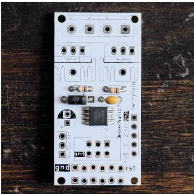
Commencez par placer les résistances et le condensateur, ils ne sont pas polarisés. Par contre, la diode est polarisée. Attention au sens
